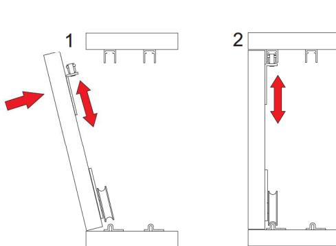
1. Vozíky se uchytí na dveře dle výše uvedeného vrtacího plánu. Horní vozíky jsou přitom v dolní poloze.
