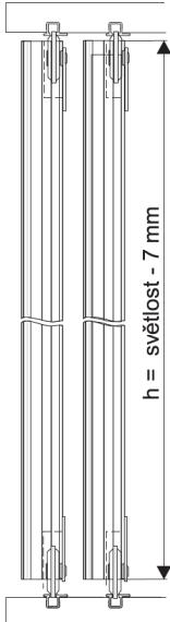
Oveřní křídlo nasazujeme nejprve do spodní kolejnice a následným stlačením kolečka horního vozíku zasadíme do horní kolejnice.
