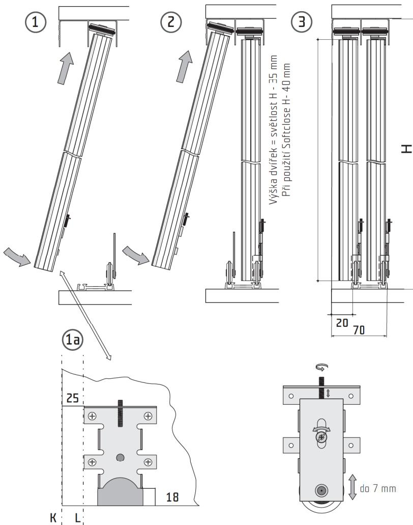
Pozor: Při montáži pevné části vozíku dbejte na to, aby osy K a L byly rovnoběžné.
