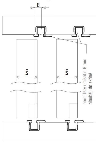
Šířka a hloubka frézování pro vodicí profil:
