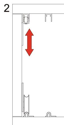
2. Po umístění dveří s vozíky do dolních lišt se zvedne horní vozík do horní lišty a po výškovém nastavení se zafixuje v požadované poloze pomocí zajišťovacích šroubů.
